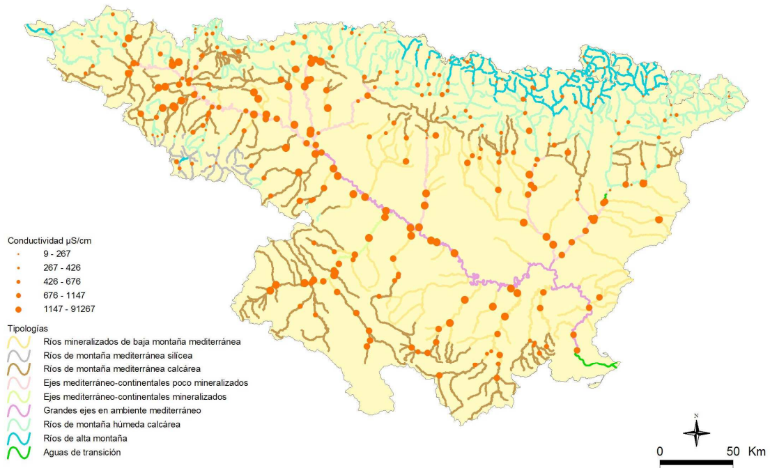
Figura 36. Conductividad ( \mu\text{S}\cdot\text{cm}^{-1} ) medida en las estaciones de muestreo en 2009.
