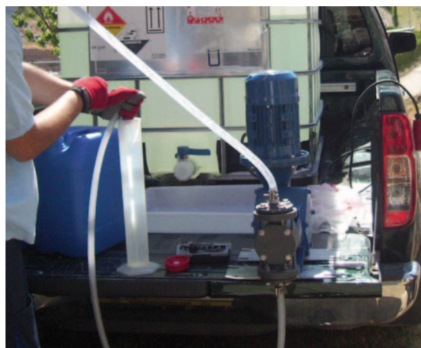
Figura 6. Aplicación de tratamiento de peróxido de hidrógeno y ácido peracético. Fuente: CEIDE-ENDESA.
