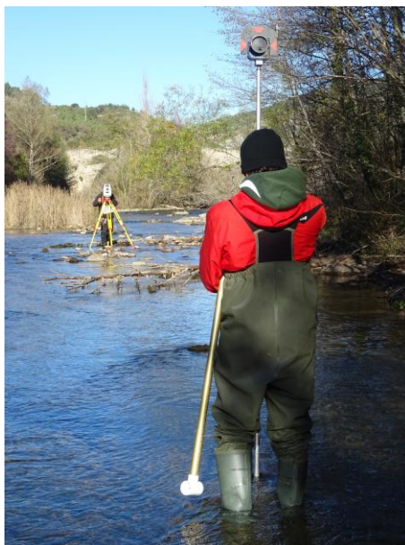
Fotografía 2. Toma de datos topográficos con estación total. Río Irati aguas abajo del embalse de Itoiz (noviembre 2023).
