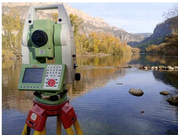
Fotografía 1. Estación Total Leika TS15 empleada en los trabajos de campo. Río Segre aguas abajo del embalse de Camarasa (noviembre 2023).
